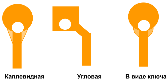
Рисунок 14: Соединения дорожек с переходными отверстиями.
