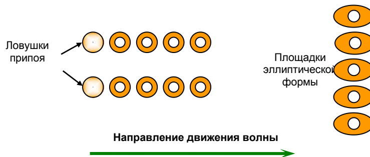
Рисунок 61: Ориентация рядов выводов относительно направления движения платы при пайке волной припоя.
