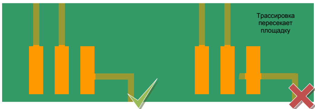
Рисунок 10: Правильное подключение дорожки к площадке.
