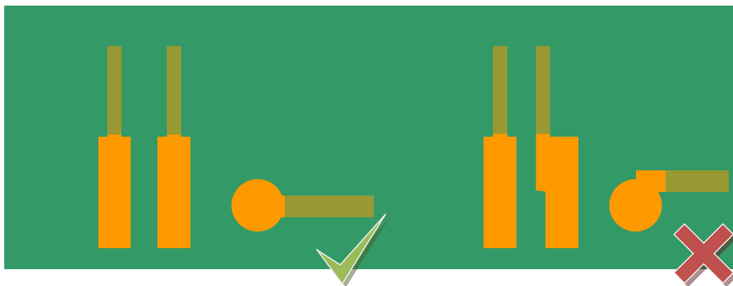
Рисунок 11: Плохая трассировка и выравнивание площадок.
