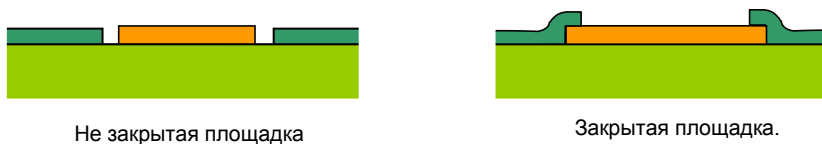
Рисунок 22: Открытие отверстий в паяльной маске для площадок
